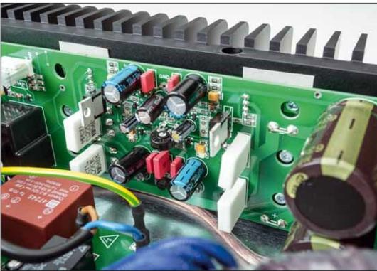
Das Endstufenmodul arbeitet mit vier kräftigen bipolaren Transistoren pro Kanal
