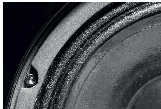
Die 21 Zentimeter großen Breitbänder weisen Membranen aus Papier auf, die aufwendig mit balsamischen Ölen und Geigenlacken behandelt wurden
