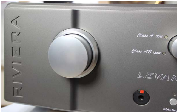
Der Riviera Levante besitzt einen dedizierten Kopfhörerverstärker, die Klinkenbuchse findet man auf der Front
