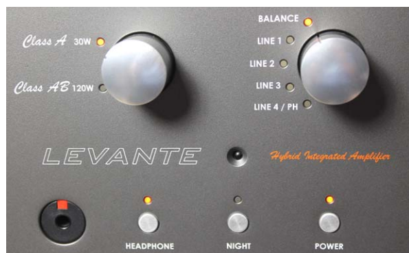
Der Riviera Levante bietet die Möglichkeit zwischen Class-A und Class-AB zu wechseln
